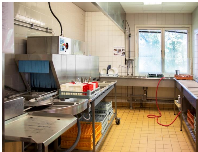
Bild 4 (ovan) Diskmaskin med in- och utmatningsband. Bild 3 (vänster) Det går åt mycket vatten vid manuell förspolning.
