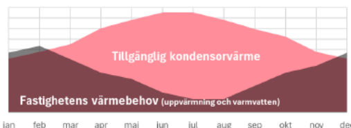
I detta exempel täcker kondensörvärme nästa hela fastighetens värmebehov under årets kallaste månader. Tillgänglig överskottsvärme är högre eller mycket högre än fastighetens värmebehov resten av året.
